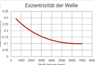
Die Dichtung nahe am Lager anbringen, um eine übermäßige Exzentrizität/Wellenschlag (TIR) zu reduzieren. Ungefähre Werte sind angegeben.
