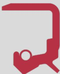
Metallischer Außenmantel für eine optimale Anpassung an das Gehäuse
